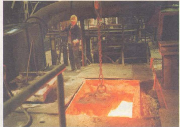
Bis zum Schluß erfolgte die Beschickung der Öfen mit Schwarzkupferblöcken oder Anodenresten von oben durch das Gewölbe, wobei der Hüttenmann der Hitze beim Einsetzen voll ausgesetzt war.
